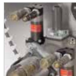
Надёжная режущая голова со стандартными гидравлическими моторами
